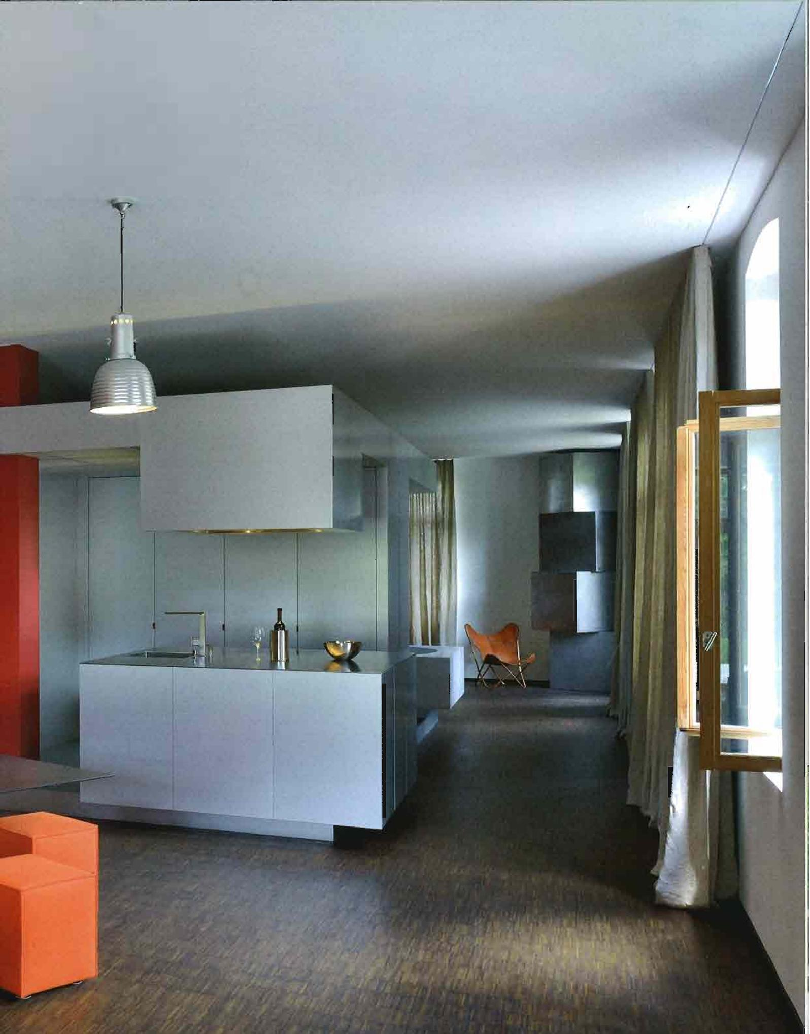
Le plan de base du loft est structuré par un noyau en forme de cube central et fonctionnel en aluminium, comprenant la cuisine, la salle de bains, un dressing et les rangements.
